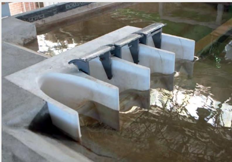
↑ Modelación física del nuevo aliviadero de la presa de Yesa (CH Ebro).
