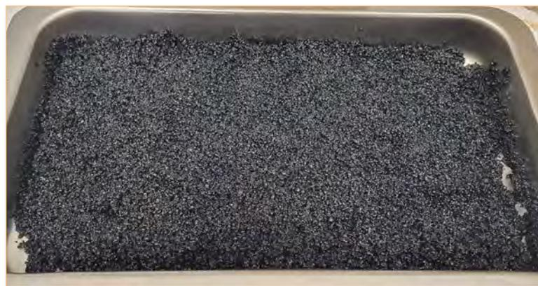
Escorias de fundición de cobre.
