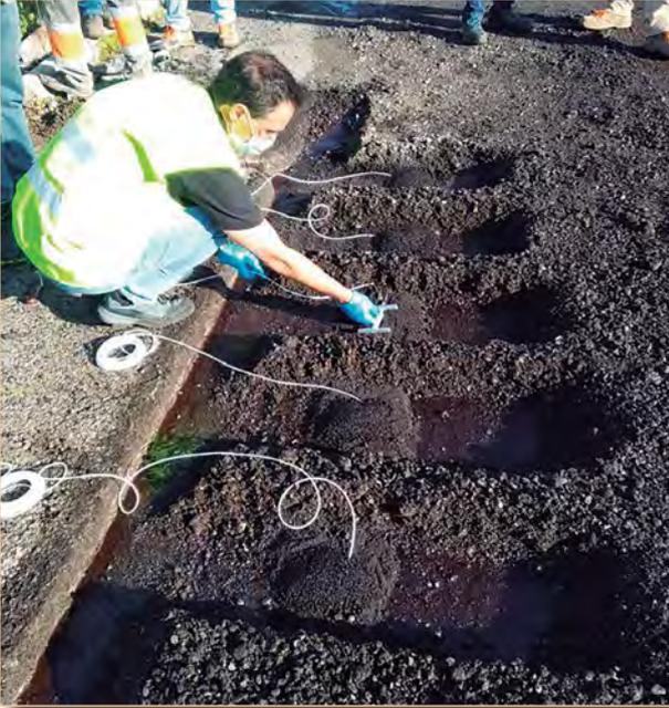
Colocación de los sensores en el firme.
