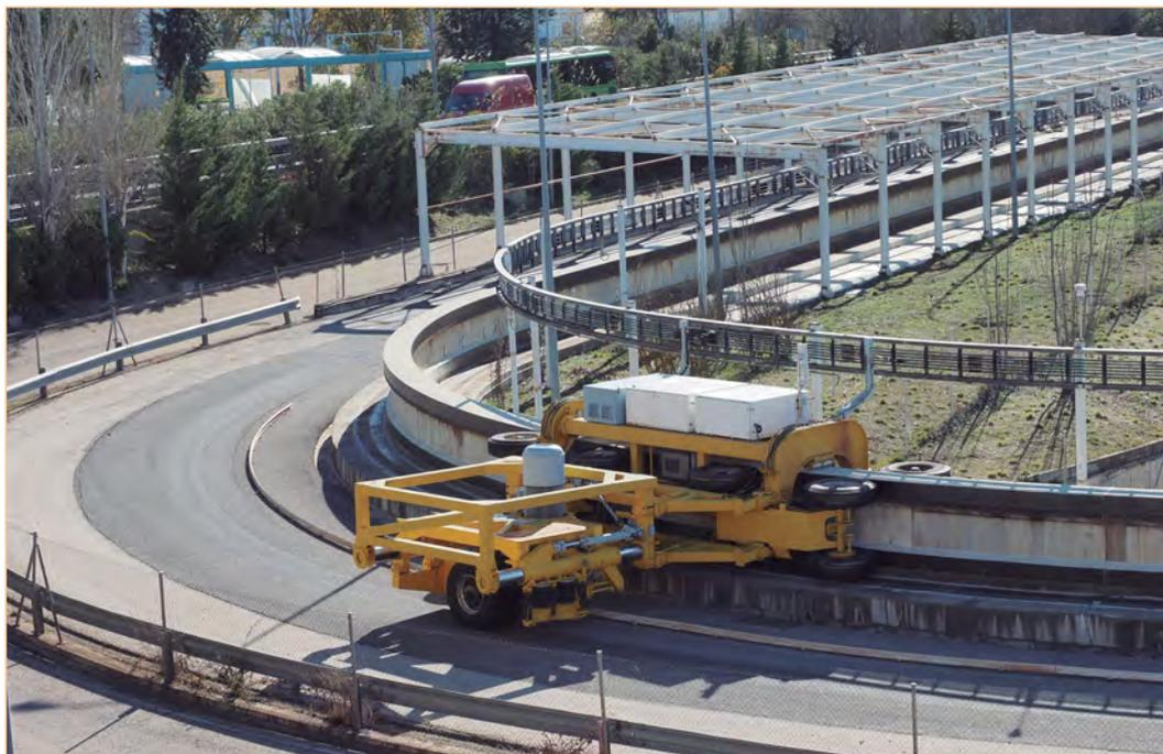
Pista de ensayo acelerado de firmes del CET.
