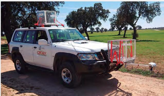
← Instalacion de dos colectores a diferente altura para los ensayos 2 y 3.
