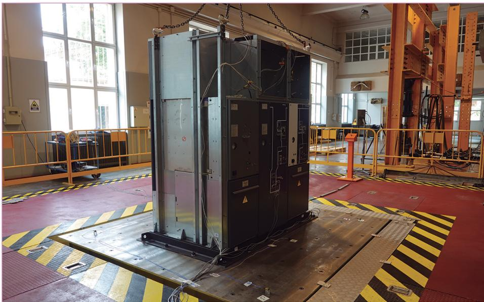
Prototipo de ensayo para calificaci n s smica.
