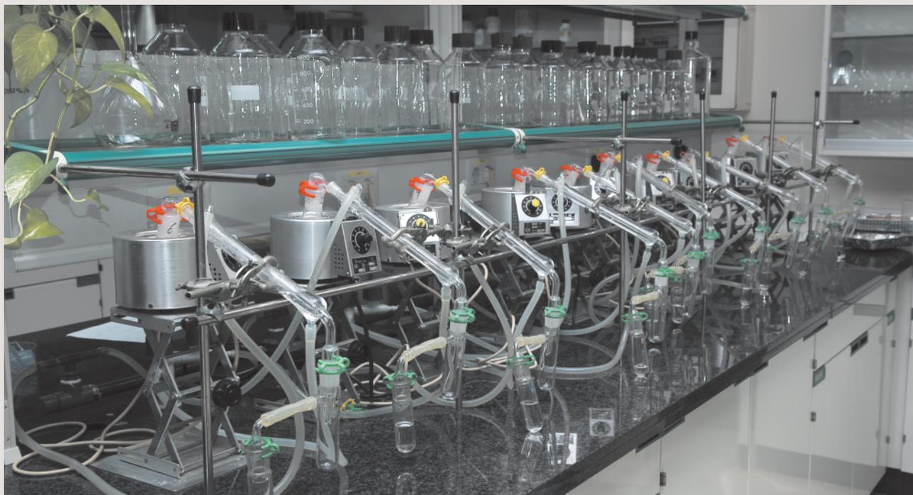
Detalle de las celdas de destilación de muestras de agua posterior a la concentración electrolítica para la medida de la actividad de tritio.
