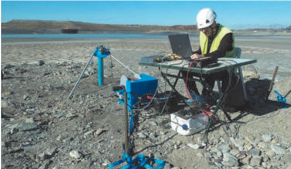
Recogida de datos con la sonda de registro-PS en la balsa de residuos mineros de Aguas Teñidas.
