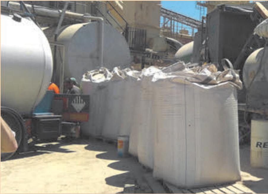
“Big bags” de polvo de caucho NFVU (neumáticos al final de su vida útil) en espera para la fabricación de una mezcla bituminosa con caucho.
