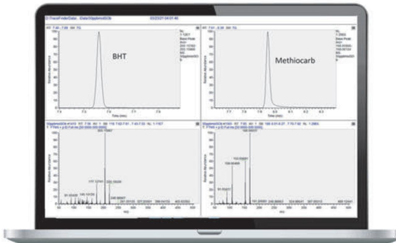
Cromatogramas y espectros de algunos de los compuestos analizados de la lista de observación por GC-ORBITRAP-HRMS.
