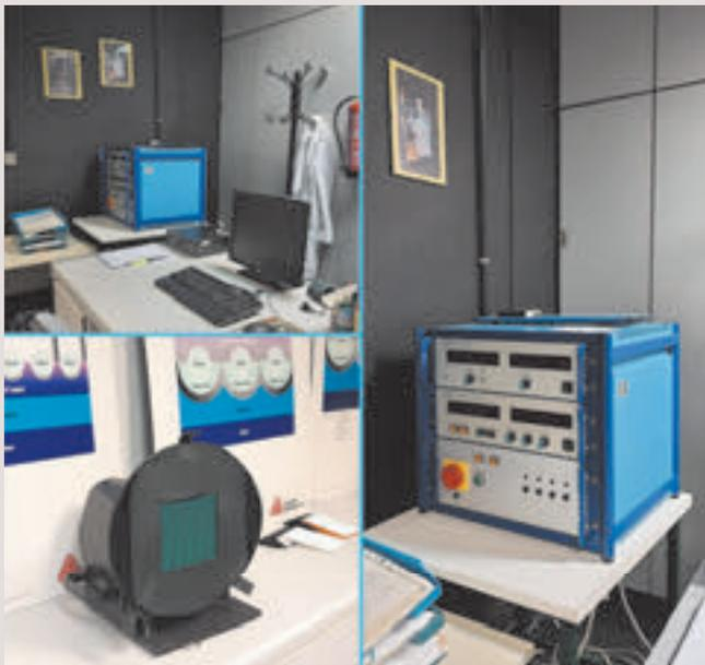
Vista de retrorreflectómetro y goniómetro.
