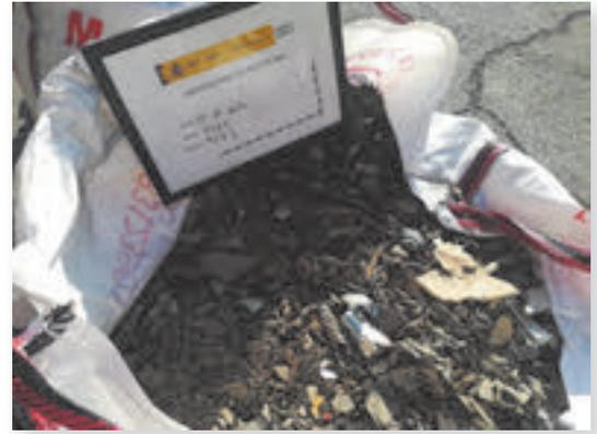
**Figura 9.** Muestra de material de un vertedero de residuos no peligrosos para ensayos de corte 1 x 1.
