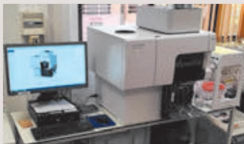
Determinación del contenido de metales mediante espectroscopía de emisión óptica por plasma acoplado inductivamente (ICP-OES). Equipo Agilent 5110 ICP-OES con tecnología Dual View (axial y radial), bajo consumo de argón, tiempos de análisis muy cortos y medida automática de hasta 250 muestras gracias a su Autosampler SPS 4.
