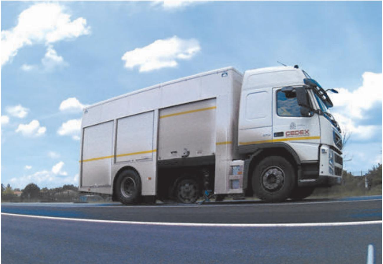
Equipo SCIM midiendo el coeficiente de rozamiento transversal del pavimento.
