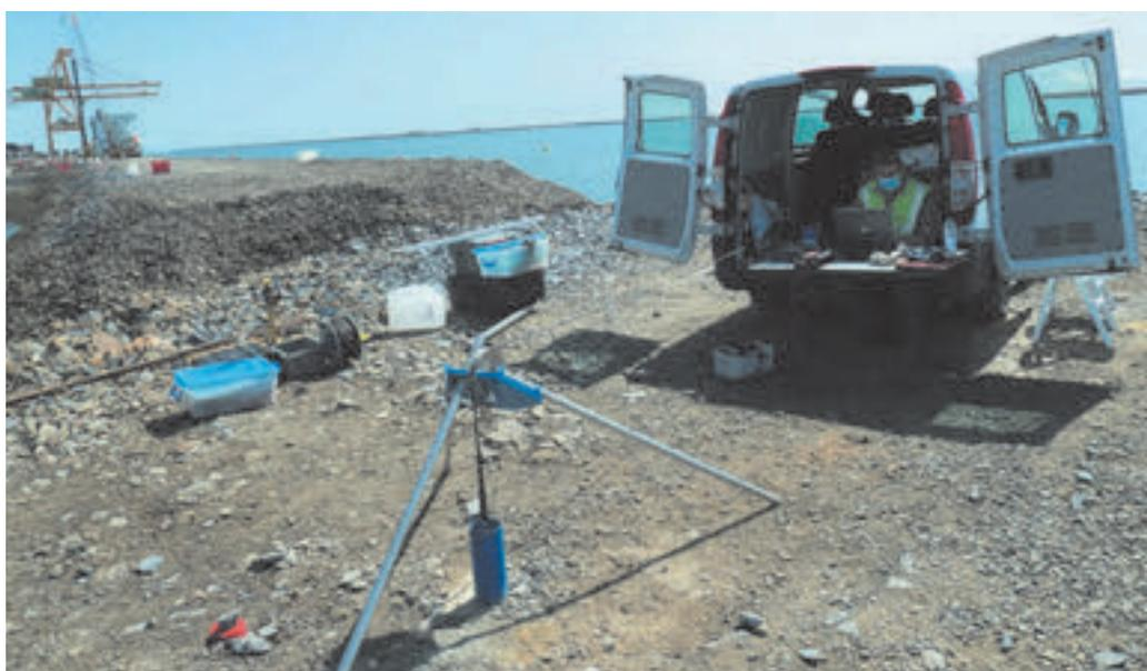
Medidas realizadas con la sonda de registro-PS en la ampliación del muelle Sur del puerto de Huelva.
