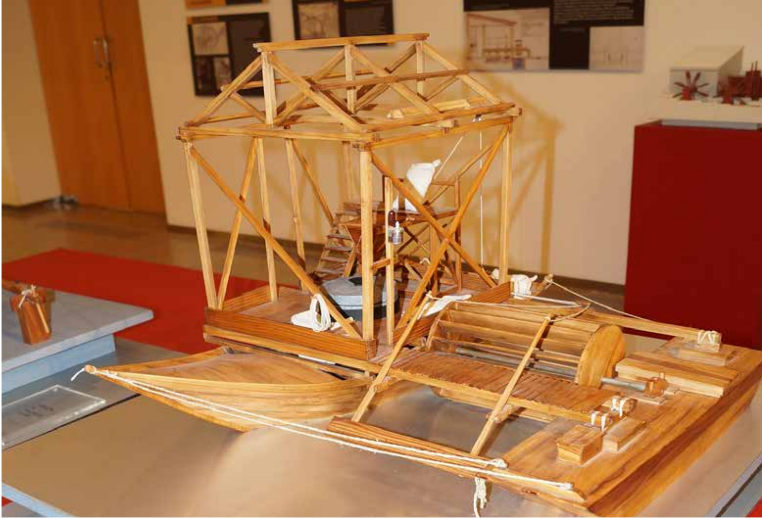
Molino de barco según un modelo de Los Veintiún Libros de los Ingenios y Máquinas
