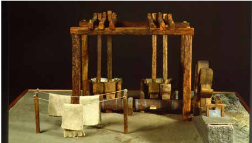
Batán movido por rueda hidráulica
