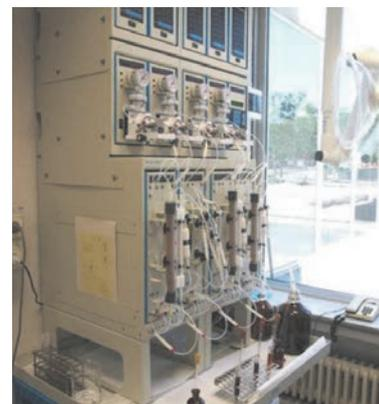
Sistema Power-Prep de fluidos automatizados para la extracción y purificación de muestras (dioxinas, PCB's, pesticidas, PAH's, etc.).
