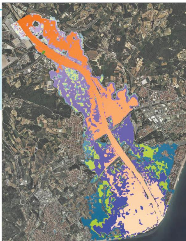
Superposición de las máximas manchas de inundación para diferentes períodos de retorno en la desembocadura del río Tordera.
