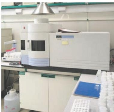
Espectrómetro de emisión atómica por plasma de acoplamiento inductivo y doble visión con nebulizador ultrasónico (ICP-OES). Análisis multielemental de metales.
