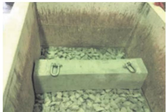
Travesía preparada para el ensayo tras ser colocada en la caja de corte.
