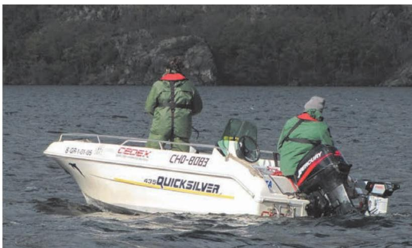
Embarcación con motor fueraborda ecosonda y mini-grúa para la utilización de diferentes tipos de tomamuestras para trabajos limnológicos en embalses, lagos y estuarios.
