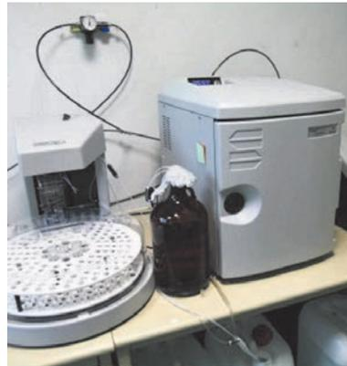
Multianalizador de microflujo segmentado continuo para el análisis de formas nitrogenadas, fosforadas, cianuros, fenoles y detergentes.
