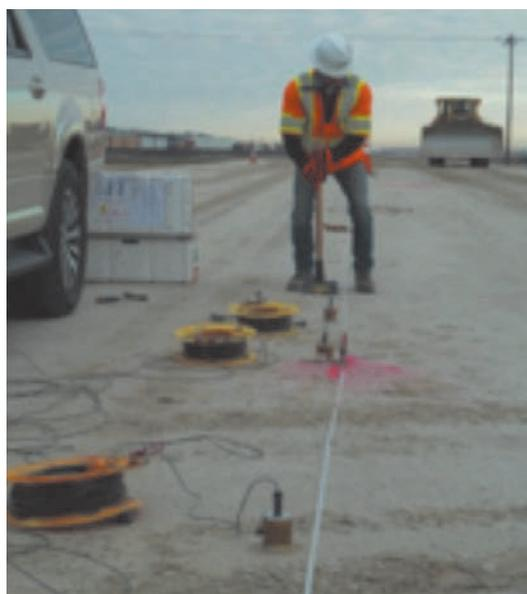
Ejecución in-situ del ensayo SASW en las obras de la futura línea de alta velocidad en California.
