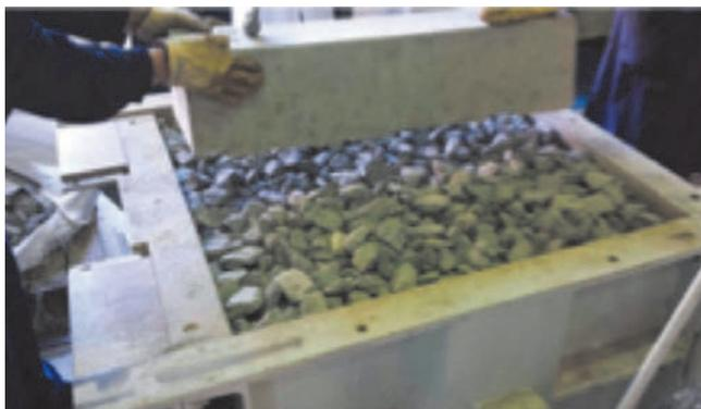
Instalación de la travesía sobre la caja de corte.
