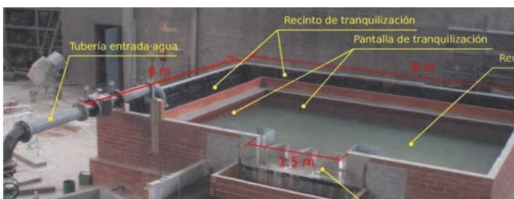
8. Instalación para el ensayo de aliviaderos especiales (laberinto, tecla de piano...).
