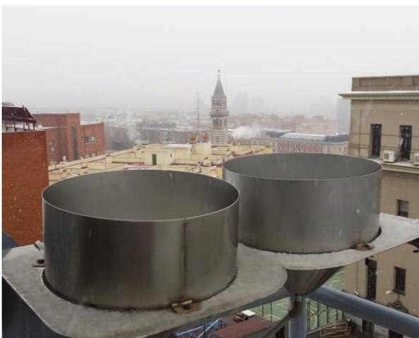
Pluviómetros de recogida de muestras de REVIP en el Laboratorio de Aplicaciones Isotópicas en Madrid.
