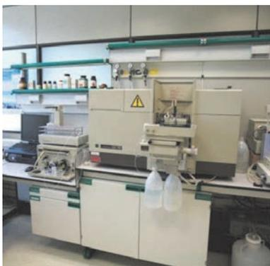
Sistema de inyección de flujo en continuo (FIMS) y sistema de absorción atómica (AAS) para el análisis de Hg y de metales en aguas.
