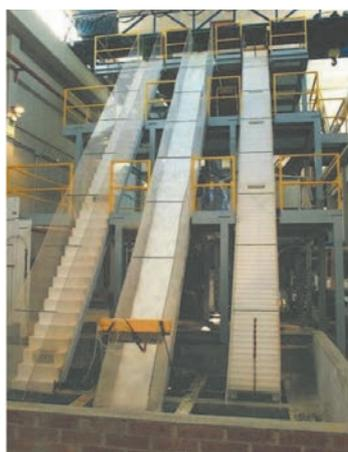
5. Instalación para experimentación, aliviaderos escalonados y de aireación forzada en aliviaderos y optimización de cuencos.
