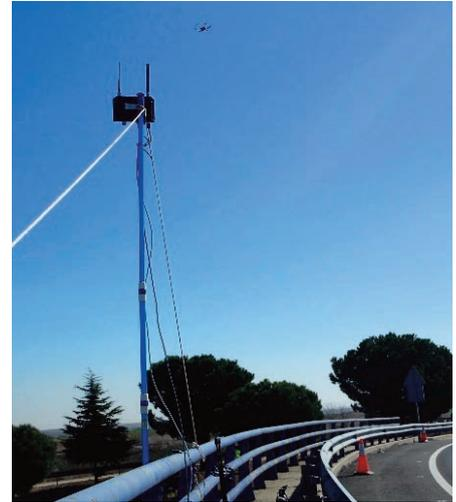
Registro con imágenes aéreas de una prueba de carga dinámica de un paso superior sobre la A5.
