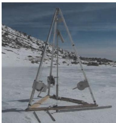
Plataforma de obtención de testigos de sedimento con corer de pistón y percusión.
