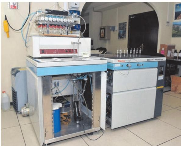
Espectrómetro de masas ligeras de doble entrada para la determinación de relaciones isotópicas.
