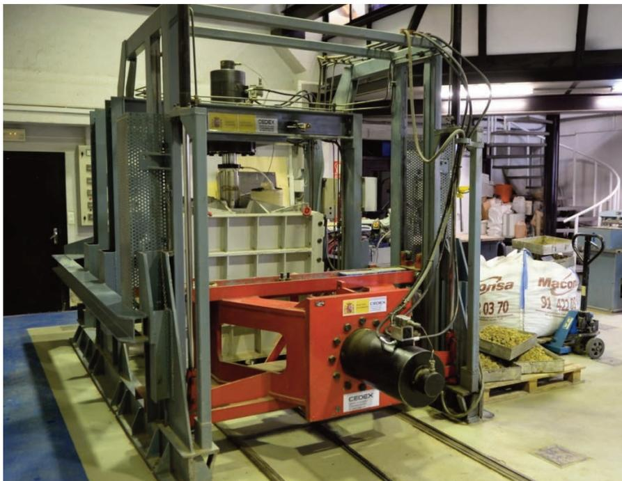
Vista general del equipo de corte directo de 1x1 m del Laboratorio de Geotecnia del CEDEX.
