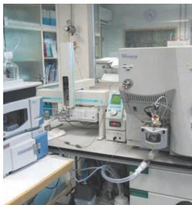
Cromatógrafo de líquidos de alta resolución con detector de masas triple cuadrupolo de alta resolución y sistema E-quan de introducción directa de muestra líquida (HPLC/MS/MS).
