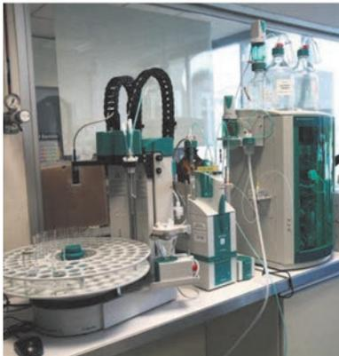
Cromatografía iónica con valorador y detectores UV/VIS, conductivímetros y amperométrico para la determinación analítica de componentes mayoritarios presentes en las aguas (Cl).
