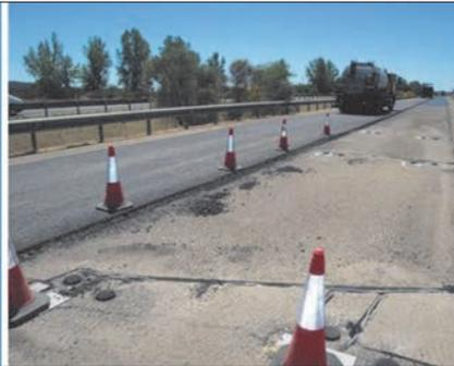
Las estaciones de auscultación automática mediante instrumentación y monitorización en tiempo real son una herramienta imprescindible para el conocimiento del estado estructural de la carretera
