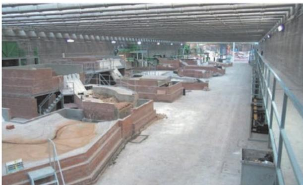
2. Nave II (6.000 m<sup>2</sup>) para la experimentación en modelo físico a escala reducida de actuaciones fluviales. Estación fija de bombeo con una capacidad 450 l/s.
