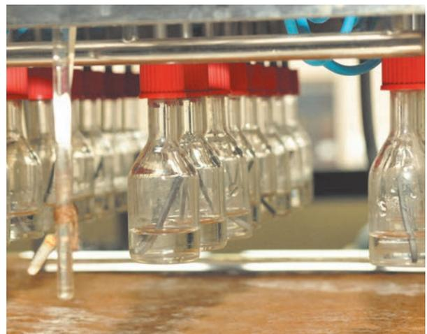
Detalle de muestras para análisis de isótopos estables de la molécula de agua.
