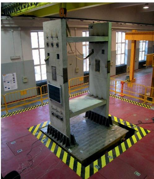
Ensayo sísmico de una estructura a escala real.
