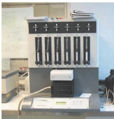
Extracción en fase sólida para muestras líquidas (Autotrace).
