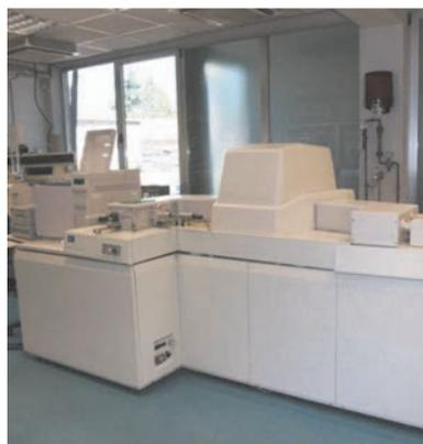
Cromatógrafo de gases de alta resolución con muestreador automático acoplado al Espectrómetro de masas de alta resolución (sector magnético) e impacto electrónico (HRGC/HRMS-EI).
