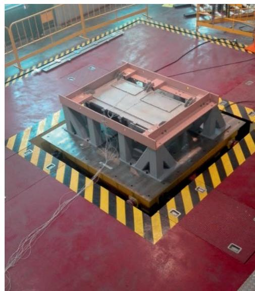
Ensayo de vibración y choque en un equipo convertidor para ferrocarril.
