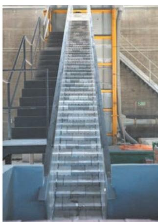
6. Instalación para experimentación de protecciones en forma de cuña en presas de materiales sueltos.
