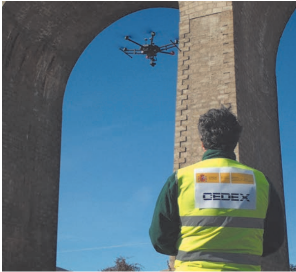
Figura 15. Inspección de puentes mediante drones.
