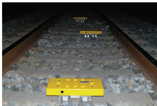
Figura 3. Ensayos en vía de balizas desplazadas.
