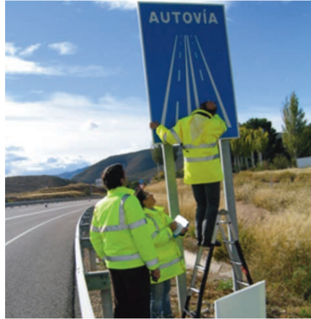
Figura 11. Medida del coeficiente de retrorreflexión de señales verticales de carreteras.
