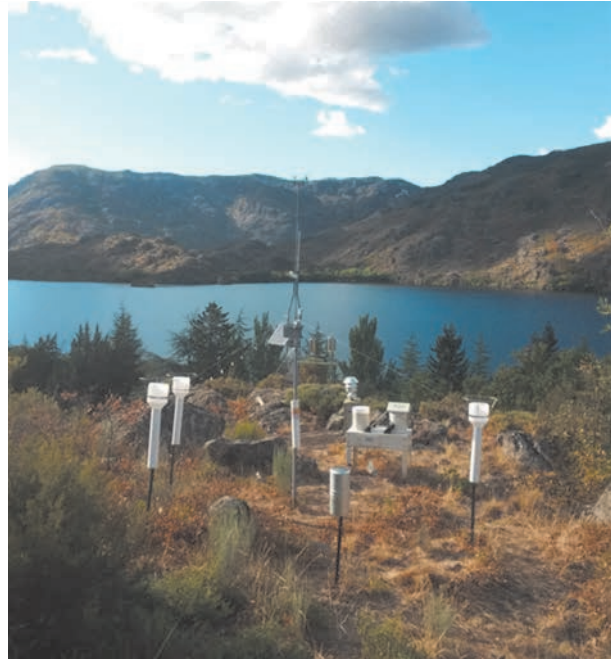
Figura 7. Toma de muestras en profundidad (izquierda) y de depósito atmosférico (derecha) en el lago de Sanabria.
