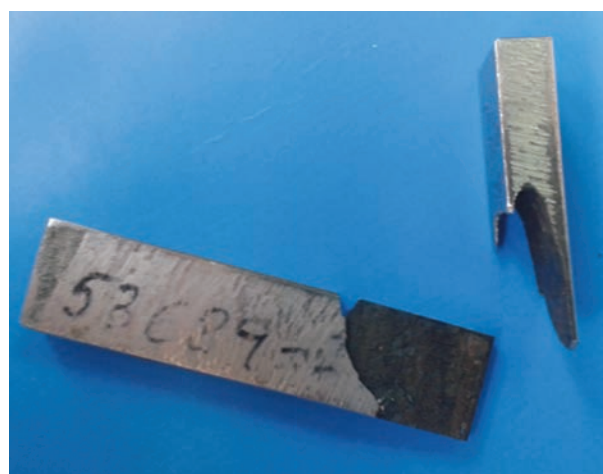
Figura 13. Fractura anómala de probeta Charpy. Ensayo de resiliencia de muestra de acero tomada de un puente.
