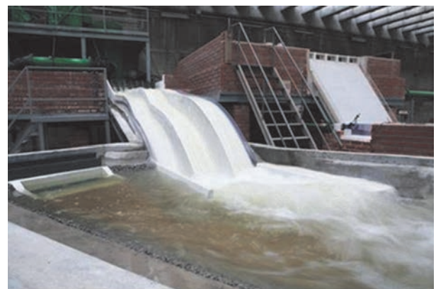
Figura 14. Modelo físico de la presa de la central de Rositas (Bolivia).
