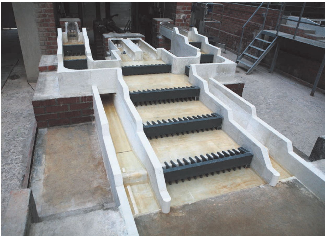
Figura 1. Modelo físico del cuenco amortiguador de la presa del Ebro (demarcación hidrográfica del Ebro).
