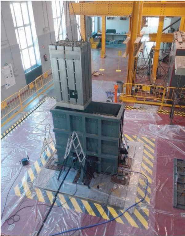
Figura 6. Ensayo de simulación sísmica. Proyecto ANSTER.
