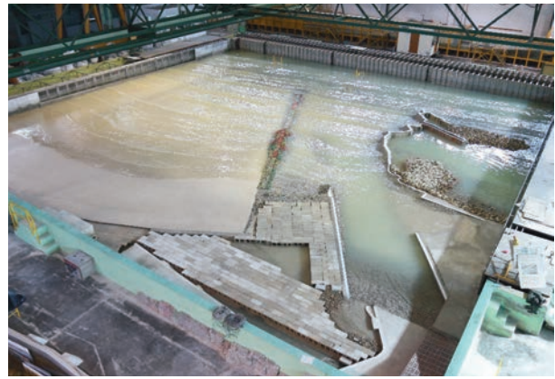
Figura 2. Ensayo en modelo físico de la prolongación del dique de contención de arenas del puerto de Avilés.
