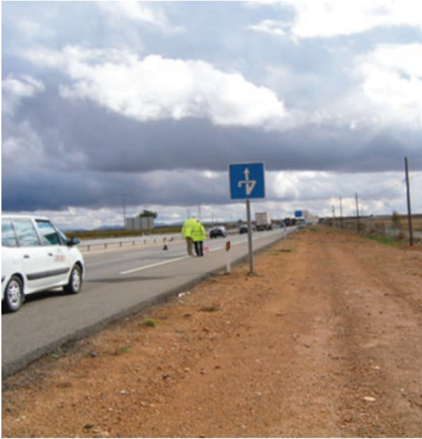
Figura 10. Auscultación de marcas viales. Medida del coeficiente de luminancia retrorreflejada.
