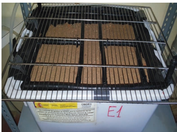
Figura 10. Ensayo cualitativo de detección de potenciales contaminantes en un árido.
