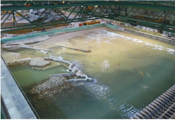
Figura 11. Modelo físico de la playa de Salinas y del dique de contención de arenas en la bocana del puerto de Avilés. Tanque de Oleaje Multidireccional. Escala 1:55.
