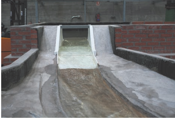
Figura 11. Modelo físico del recrecimiento del aliviadero de la presa de El Andévalo (demarcación hidrográfica del Tinto, Odiel y Piedras).
