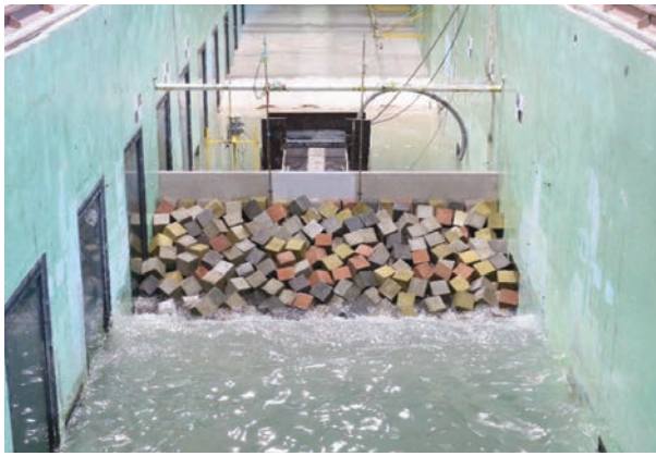
Figura 4. Rebases en diques de abrigo. Instrumentación del modelo. Escala 1:15. Canal de Oleaje y Viento de Gran Escala.
