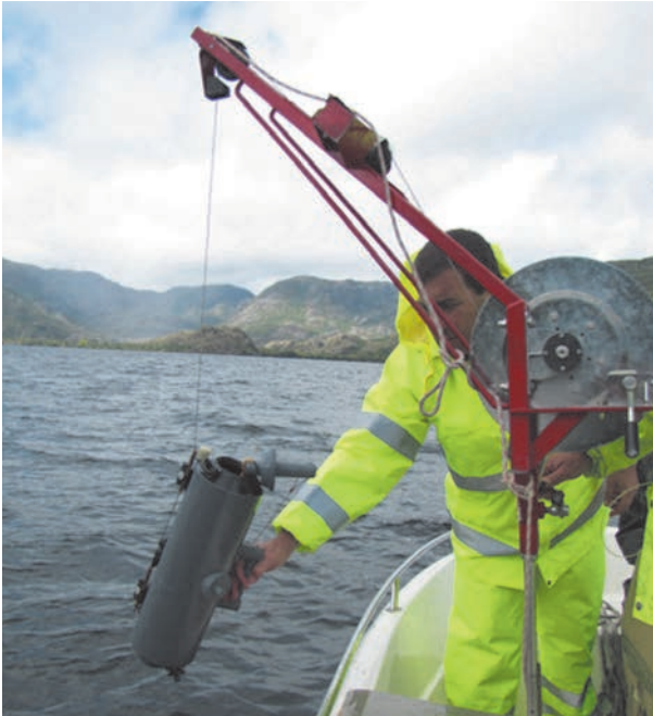
Figura 7. Toma de muestras en profundidad (izquierda) y de depósito atmosférico (derecha) en el lago de Sanabria.
