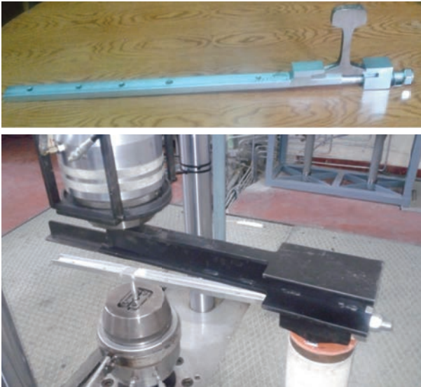
Figura 14. Ensayo de fatiga de perfil metálico portante de baliza ERTMS, para vía ferroviaria de alta velocidad.
