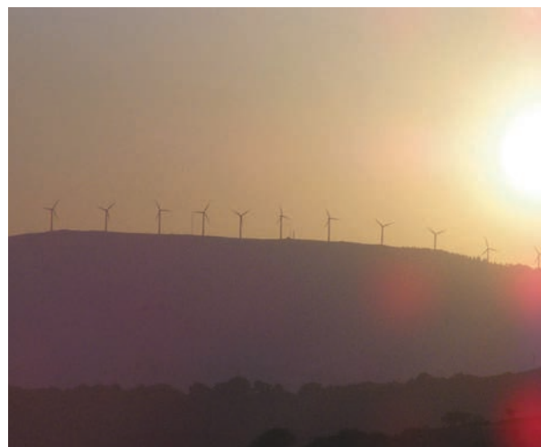
Figura 4. Cuando el parque eólico coincide con la línea del horizonte es importante que las turbinas posean una relación visual sencilla con el horizonte, evitando alturas variables, un espaciamiento excesivo o la superposición visual de los aerogeneradores entre sí. Matamorosa (Cantabria).
