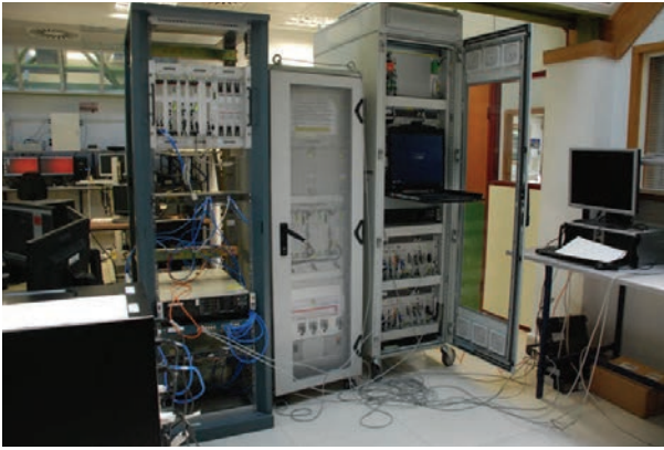
Figura 9. RBCs de Alstom y Bombardier en los ensayos de handover en el LIF.
