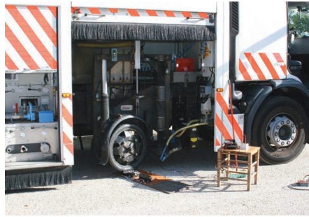
Figura 6. Intercomparación de equipos de medida del coeficiente de rozamiento transversal.
