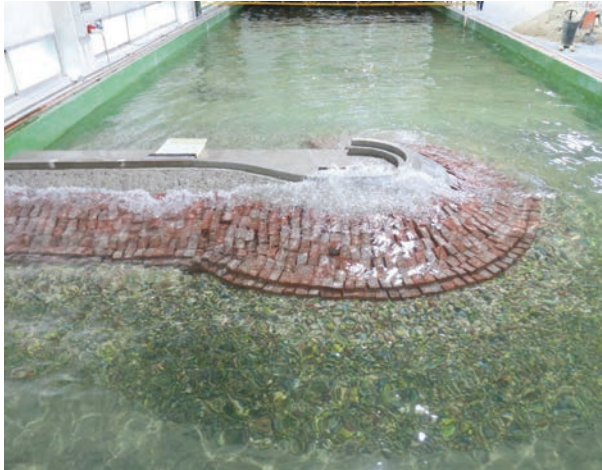
Figura 17. Ensayo del dique de la Estación Naval de la Algameca. (Cartagena, Murcia).
