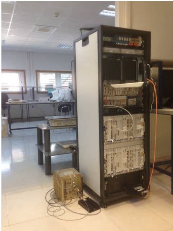
Figura 7. Equipo embarcado ERTMS de Ansaldo ensayado para su certificación, SS-076 BL3 en el LIF.
