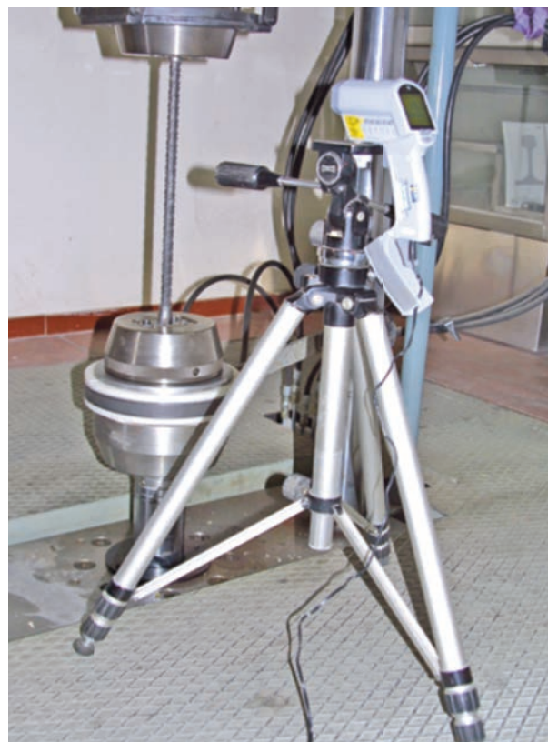
Figura 12. Seguimiento sin contacto de la temperatura de una barra de acero sometida a ensayo de fatiga.
