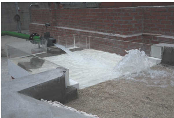
Figura 13 Modelo físico del desagüe de fondo y del cuenco amortiguador de la presa de Pálmaces (demarcación hidrográfica del Tajo).
