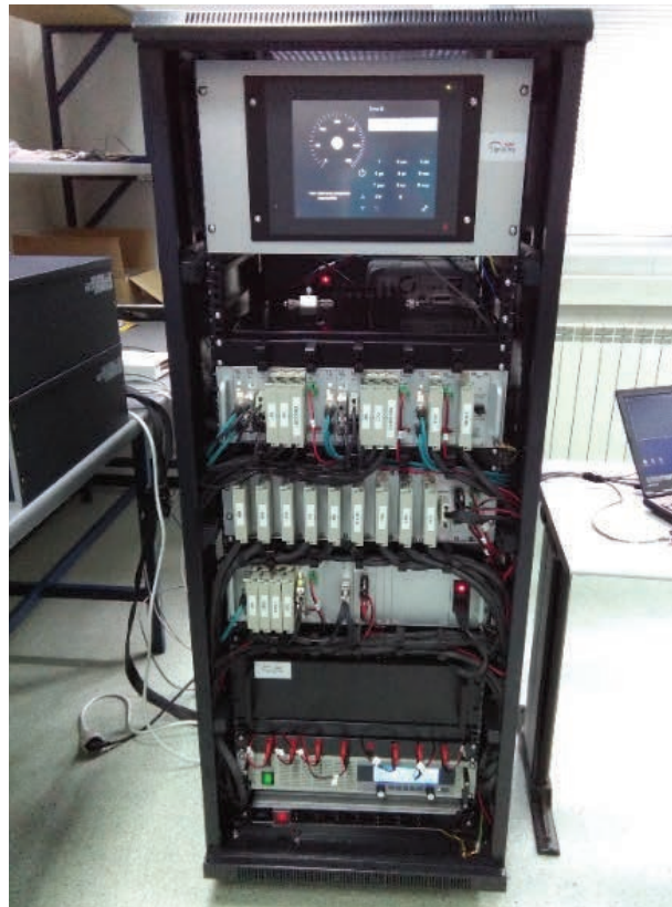
Figura 6. Equipo embarcado ERTMS de CAF ensayado para su certificación SS-076 BL2 en el LIF.
