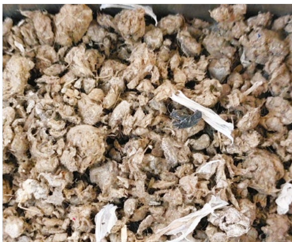
Residuo de celulosa con restos poliméricos empleado en una mezcla SMA.
