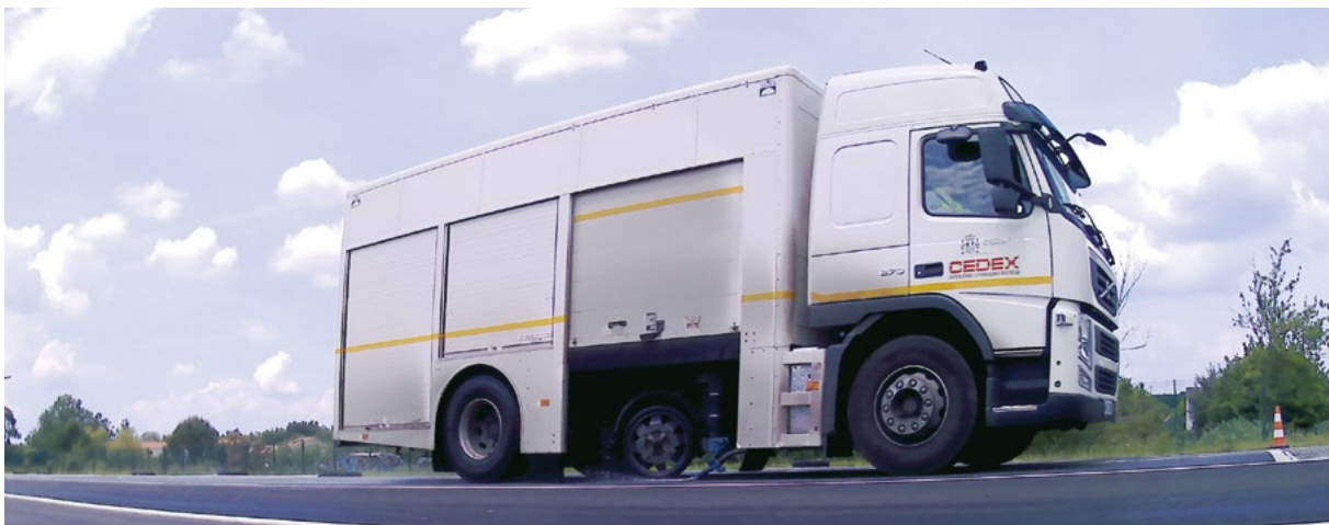
Equipo SCRIM midiendo el Coeficiente de Rozamiento Transversal (CRT) del firme.
