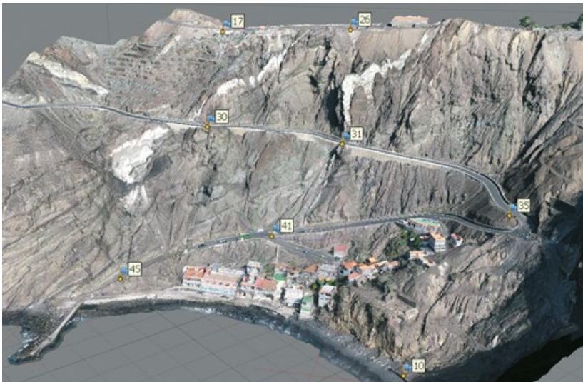
Figura 1. Modelo digital del terreno elaborado a partir de fotogrametría con dron.
