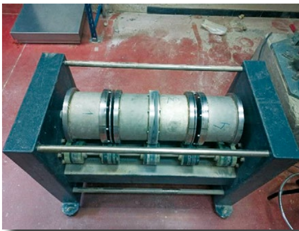
Figura 3. Equipo Micro Deval del LG-CEDEX utilizado para los estudios de degradación del balasto.
