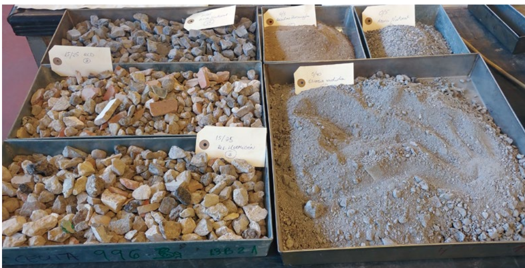
Áridos RCD y escorias de incineración de RSU para fabricación de hormigón.
