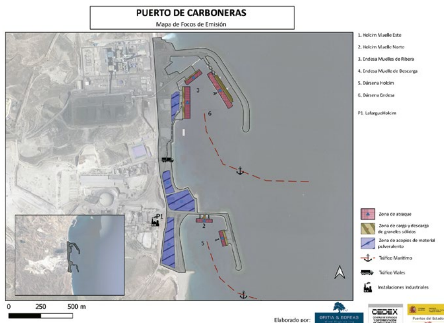
Esquema en planta de focos de emisión de muelles, actividades industriales y transporte terrestre del puerto de Carboneras.
