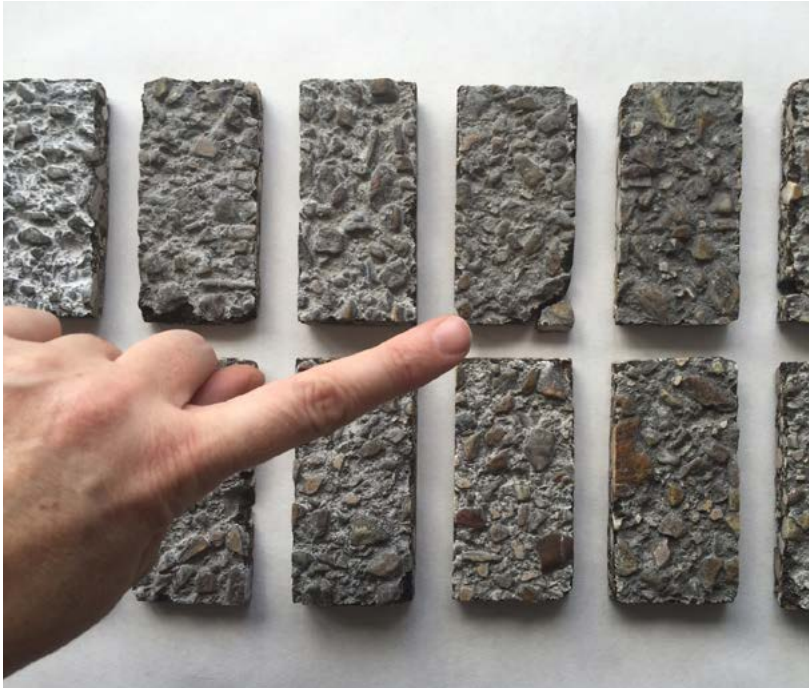
Probetas de mezcla bituminosa extraídas del P° de la Chopera tras diferentes tiempos de exposición al tráfico
