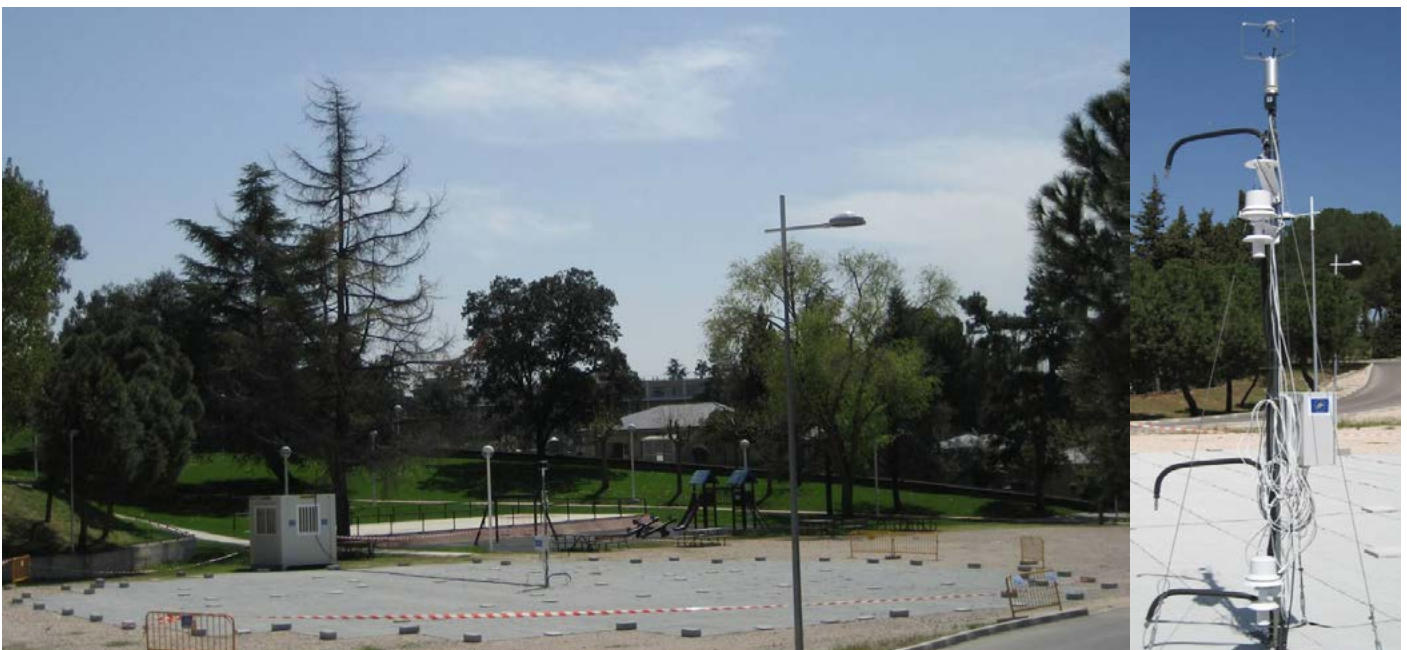
Plataforma experimental (izqda.) y mástil con sensores meteorológicos y tomas de muestras (dcha.)
