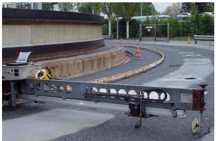
Medida de regularidad transversal en la pista de ensayos
