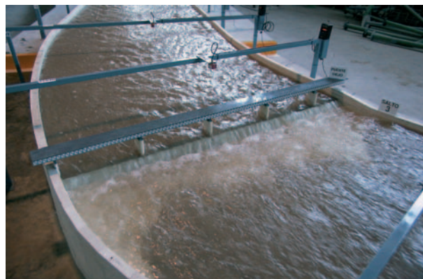
Modelo físico para el estudio del río Andarax.
