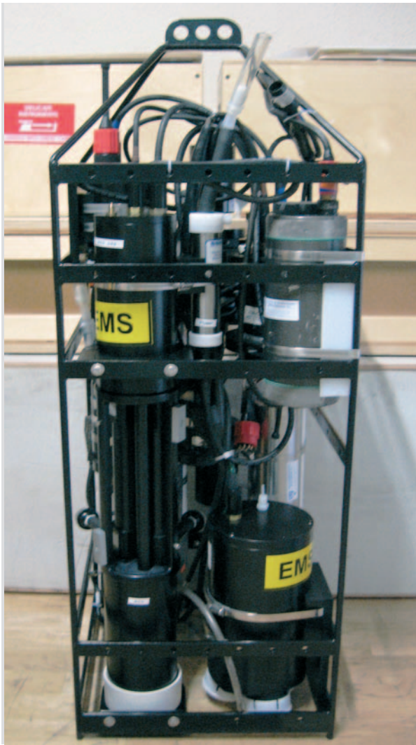
Conjunto perfilador multiparamétrico, con fluorómetros de pigmentos fotosintéticos, sensores de propiedades inherentes del agua, y otros parámetros fisicoquímicos.
