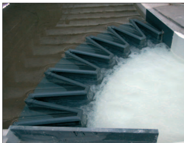
Modelo físico del aliviadero en laberinto proyectado en la presa de M a Cristina.
