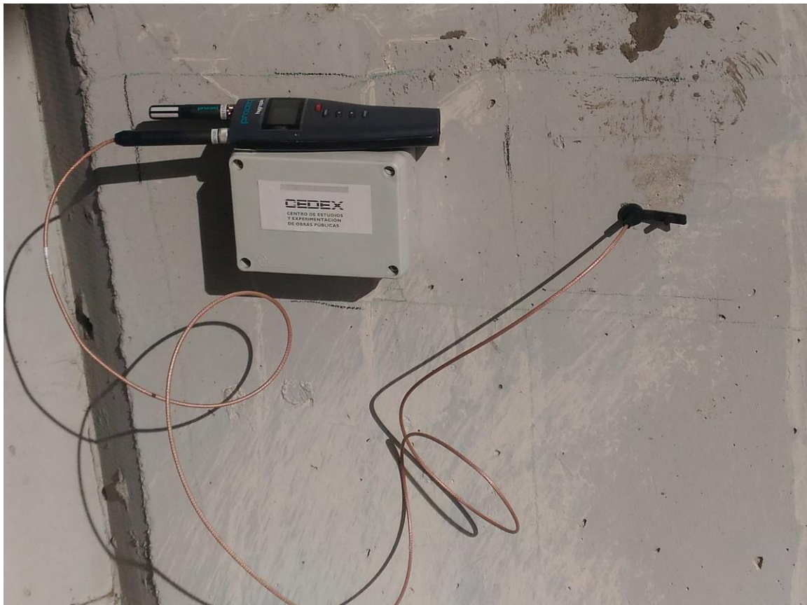
Ilustración 2.- Sistema de medida y adquisición de datos de temperatura y humedad instalado, así como equipo de medida manual para contraste de resultados.
