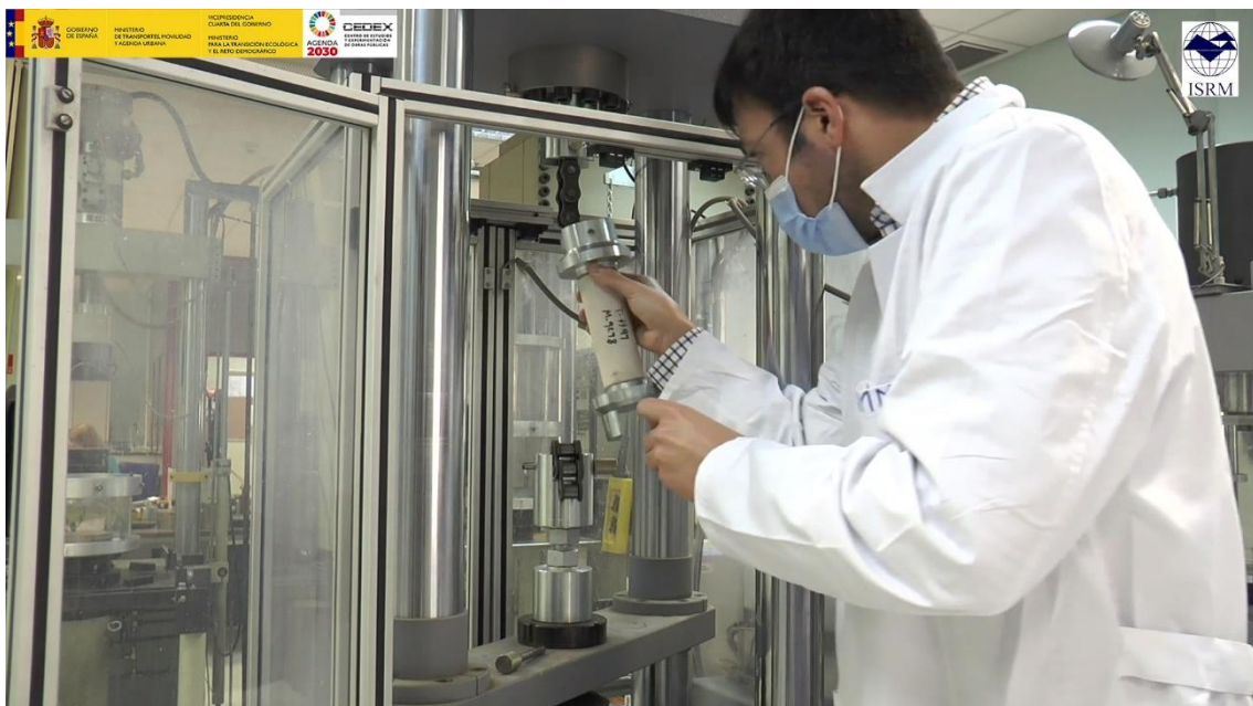
Ilustración 1.- Colocación de la muestra en la prensa de ensayo
