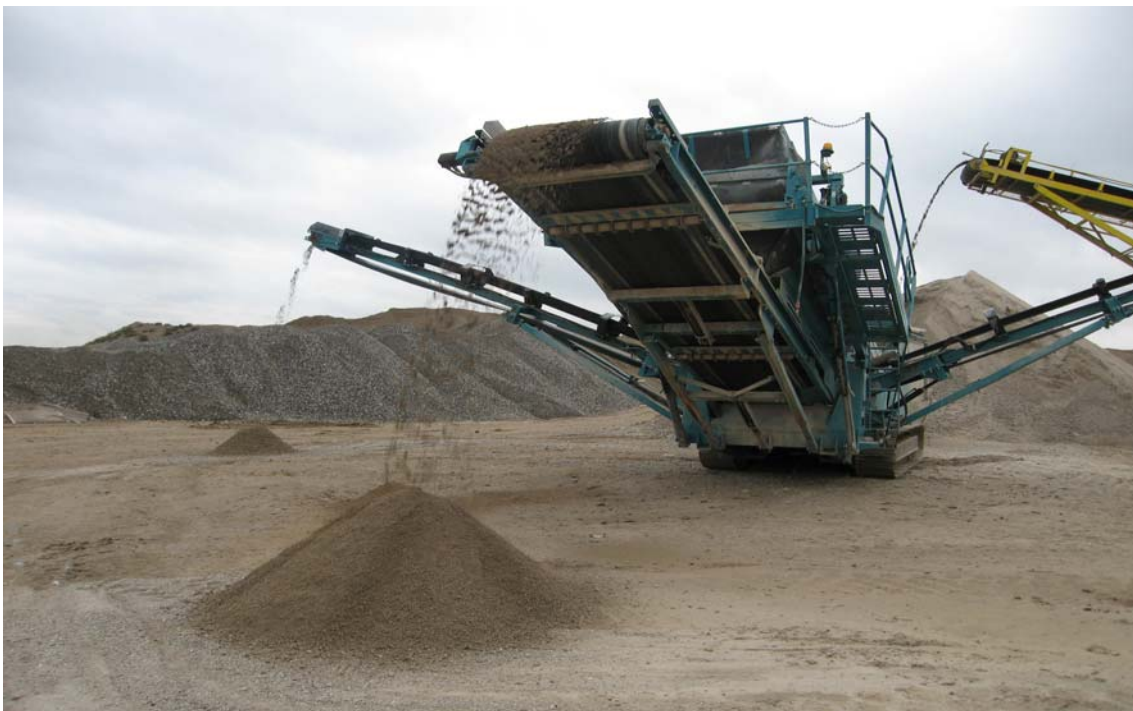
Ilustración 3.- Reciclado de hormigón de vigas antiguas
