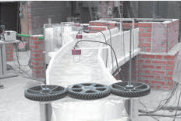
Physical model of the Canal del Enlace Directo (Huelva).
