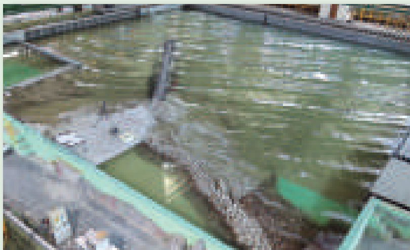
Figura 6. Ampliación del puerto de Aberdeen (Reino Unido). Ensayos en modelo físico. Fase final y etapas constructivas.
