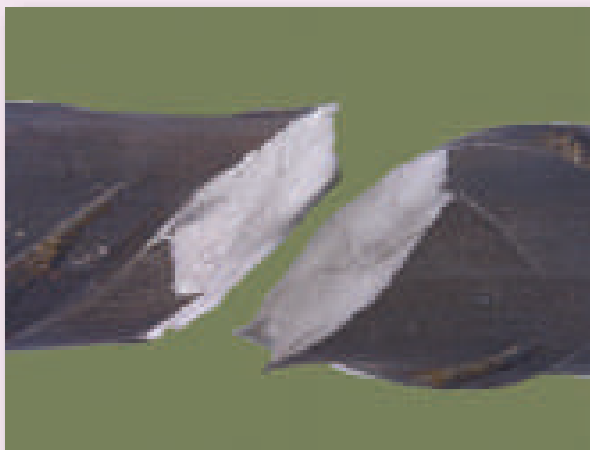
Arriba. Fractura de barra de acero inoxidable.
