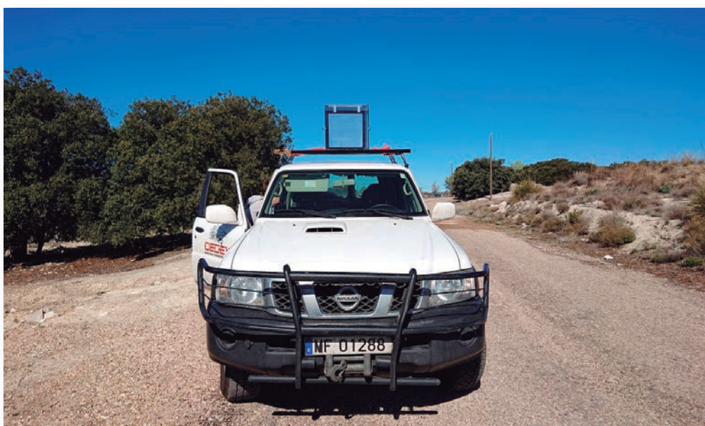
Colector de polinizadores instalado sobre el vehículo para realizar los ensayos.
